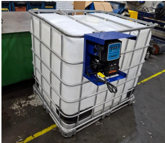
Figura 12 - Reservatório IBC com instalação do kit de abastecimento
