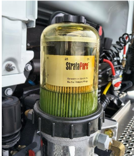
Figura 10 - Pré-filtro sem presença de água e resíduos
