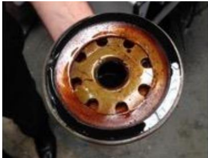
Figura 14 - Formação de verniz em filtro de combustível
