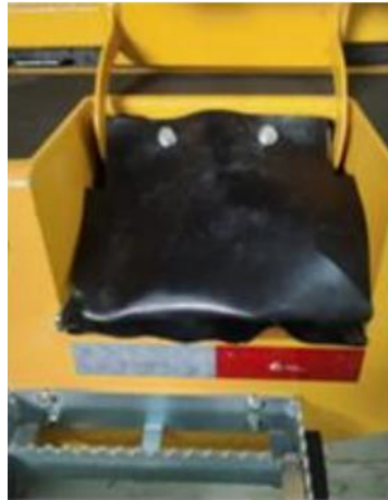
Figura 8 - Proteção do bocal de abastecimento em máquinas agrícolas
