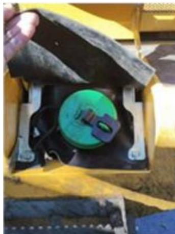
Figura 9 - Proteção do bocal de abastecimento em máquinas agrícolas
