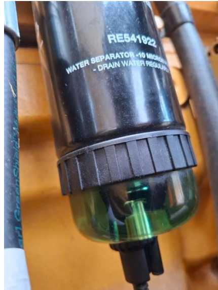
Figura 5 - Pré-filtro sem a presença de água/resíduos
